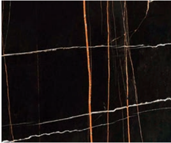
VENATURA ECCESSIVA HIGHLY MARKED VEIN
