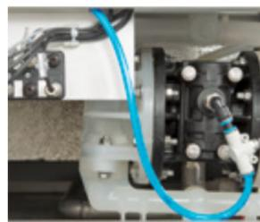
Sichere Pneumatikmembranpumpe für die Filtrierung
