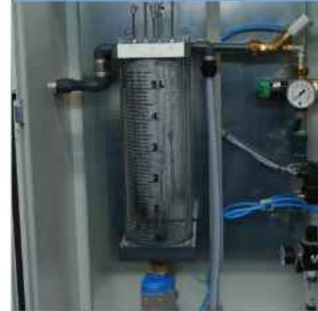
Der volumetrischen Zusatzmittel-Dosieranlage DOSIMATIC EK 2-5 P liegt das Prinzip der Füllstandsmessung zugrunde. Im Dosierbehälter befinden sich 4 verstellbare und in ihrer Empfindlichkeit justierbare Füllstandssonden. Damit lassen sich bis zu 4 verschiedene Dosiermengen automatisch ansteuern.
