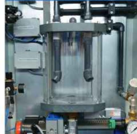
Elektromechanische Einkammerwaage mit DMS-Aufnehmer für 10 kg Nettoeinwaage. Dosierung von 1-4 Sorten. In den Wiegebehälter führt zusätzlich eine Leitung mit Sprühdüse für die automatische Wasserspülung. Die Entleerung des Wiegebehälters erfolgt im freien Fall direkt in den Mischer. Die Anlage ist komplett im staub- und spritzwassergeschütztem Stahlblechgehäuse montiert.
