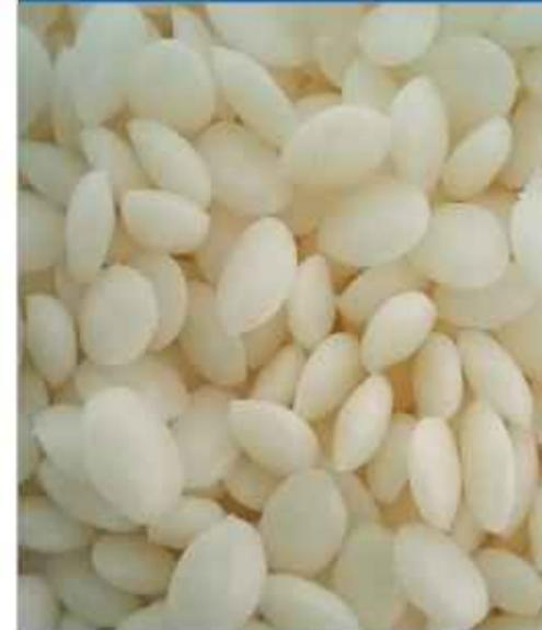
PAVELITH® InterLay NP-2 dient als werksseitig aufgebracht Kratz- und Lagenschutz für horizontal abgelegte Betonwaren. Das Produkt überzeugt mit guter Hydrolysebeständigkeit und geringer Wasseraufnahme und besteht aus biologisch abbaubaren Polymeren. Die Zusammensetzung ermöglicht einen Abbau durch Verrotten in der Natur.
