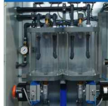
Elektromechanische Doppelkammerwaage mit eichfähigem Messaufnehmer für 2 x 10 kg Nettoeinwaage. Dosierung von 2-4 Sorten. In den Wiegebehälter führt zusätzlich eine Leitung mit Sprühdüse für die automatische Wasserspülung. Die Entleerung des Wiegebehälters erfolgt im freien Fall direkt in den Mischer. Die Anlage ist komplett im staub- und spritzwassergeschütztem Stahlblechgehäuse montiert.
