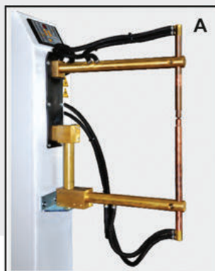
Opcja 4638 - dodatkowe elementy umożliwiające zmianę rozstawu ramion ze standardowego 320mm, na mniejszy 195mm lub większy do 500mm.
