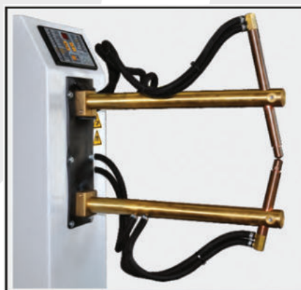
Zmiany wysięgu ramion i pochylenia uchwytów elektrod dla standardowej zgrzewarki 4660-4661-4662-4663
