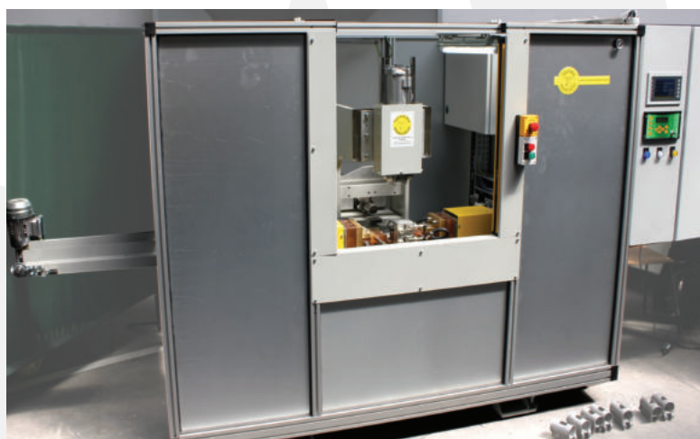
Stanowisko do zgrzewania garbowego obejmę amortyzatora samochodowego. Zgrzewarka DC 400 kVA.
