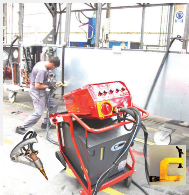
Zgrzewanie jednostronne karoserii autobusu. Zgrzewarka inwer­to­rowa TECNA 25 kVA z chłodzo­nym pisto­le­tem i ma­szą.
