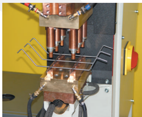
Zgrzewanie wielopunktowe prętów, Zgrzewarka TECNA 100 kVA z przyrządem.
