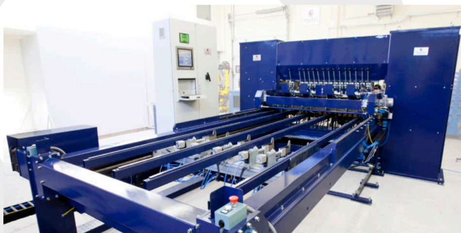
Zgrzewarka wielopunktowa prądu stałego 1x400 kVA DC z podajnikiem prętów poprzecznych.
