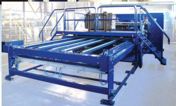
Zgrzewarka wielopunktowa do siatek z automatycznym podajnikiem prętów poprzecznych. 26 zespołów siłowni- ków dociskowych. Moc 2x400kVA DC.
