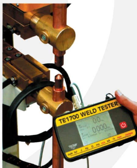
Pomiar prądu zgrzewania.
