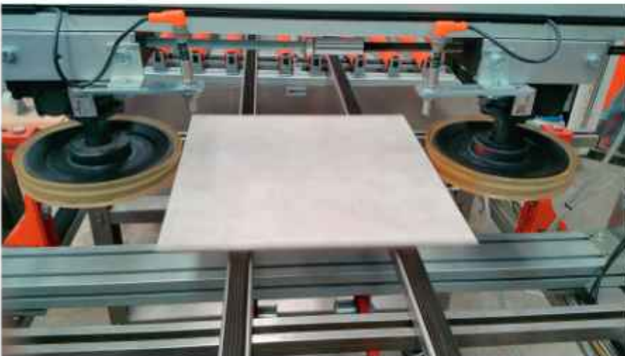
78) PP – Pareggiatore di piastrelle con fermo meccanico a ruota. 78) PP - Tile centring unit with mechanical wheel backstop.
