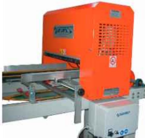
78) RQ – Sdoppiatore di piastrelle motorizzato su linea. 78) RQ – Aligner for overlapping tiles.
