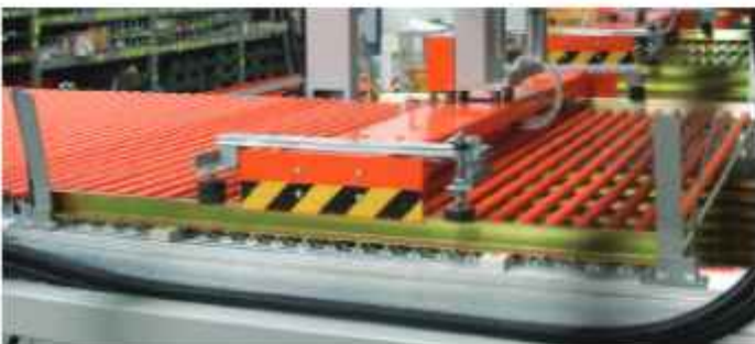
61) MCT – Macchina di carico/scarico piastrelle, da cestelli, con pinze di prelievo. 61) MCT – Machine for loading/ unloading baskets for tiles, with gripper.
