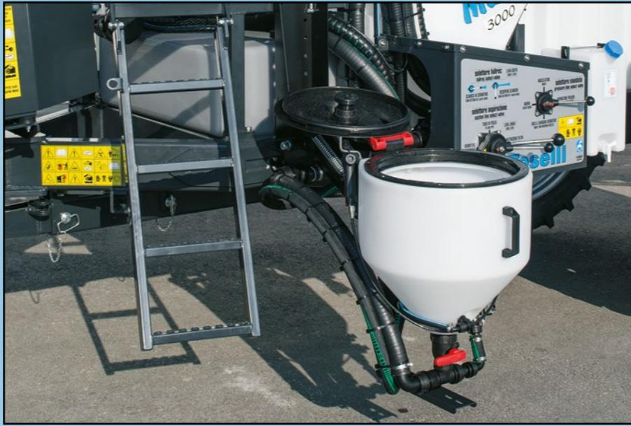
Marvel TN è stata progettata per assicurare **ergonomia e sicurezza** in ogni fase operativa; riempimento, preparazione miscela e lavaggio circuito vengono eseguiti a terra dalla medesima posizione, **accelerando le operazioni e diminuendo i rischi per l'operatore**.
