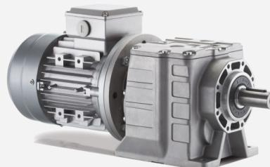
La serie dei riduttori a ingranaggi tipo RD, costruita con carcassa fusa in unico pezzo e con supporto interno per alloggiare 2 o 3 copie di ingranaggi, è costruita secondo le norme di progettazione ISO e con l'ausilio di programma di analisi strutturale per verifica della deformata e dello stress.
