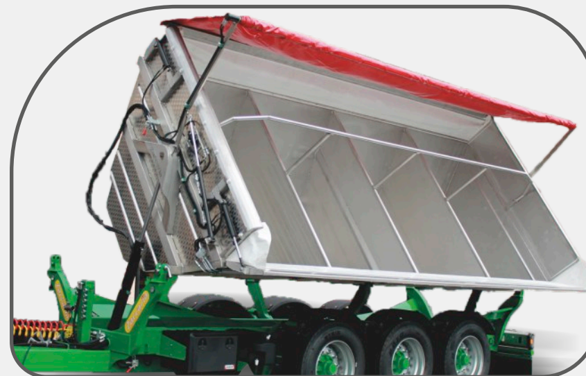
Copertura laterale (solo lato Dx) a funzionamento pneumatico azionato da radiocomando. Anche nella versione apertura lato Dx e Sx.
