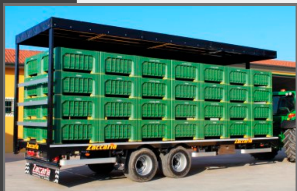
Centina autoportante MOD. ZC regolabile in altezza con telo in PVC colonne idrauliche regolabili in altezza. Copertura in PVC con tetto fisso. Barra di protezione posteriore.
